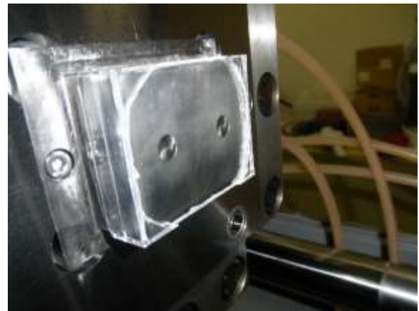
図7. 成形品の離型不良
