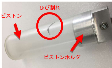
図5 ピストンのひび割れ
