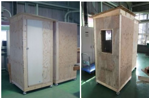
図 4 実験に使用した模擬家屋 (床面 900×900mm 高さ 1800mm)
