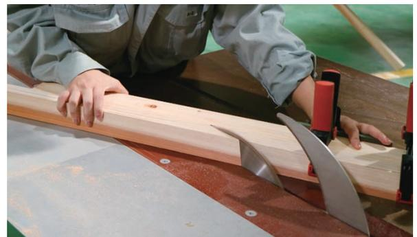
図 9 丸のこ盤による加工
