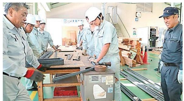
図 16 実習の様子 (鉄筋の曲げ加工)
