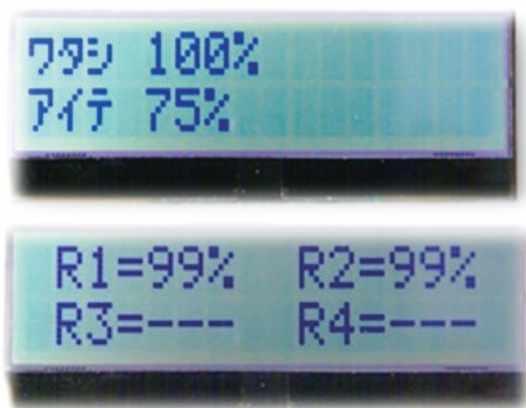
図 10 無線機の電池残量表示例
