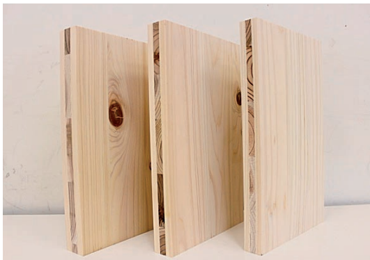
写真2 三層クロスパネル（左から厚 30、24、21 mm）
