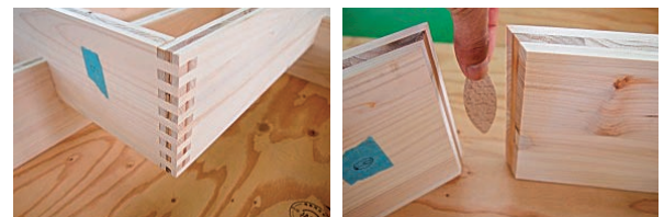
写真8 L形部の継手（左）とビスケットジョイント（右）
