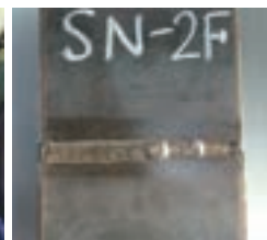
中板突合せ溶接施工例
