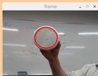
OpenCV を用いたカメラ映像の画像処理による丸い物体検知・認識画面
