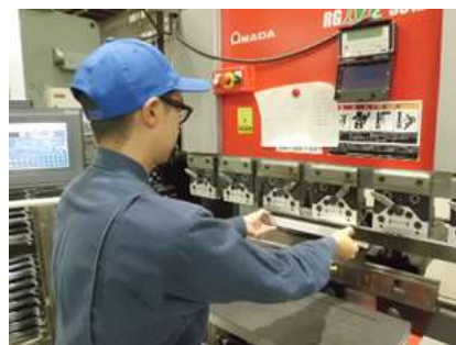
プレスブレーキによる板金加工
