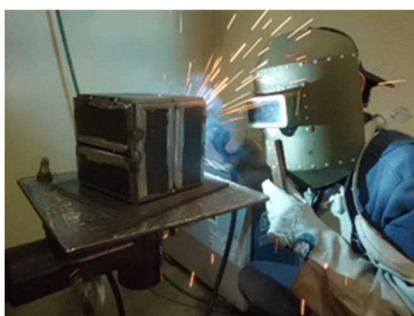
半自動アーク溶接作業
