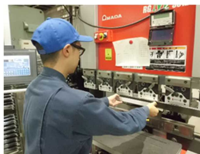
プレスブレーキによる板金加工
