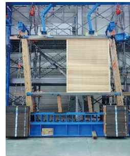
(a) -方向加力 (b) +方向加力 写真3 建具の滑動(M試験体)
