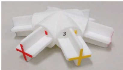
図 12 3D プリンタで制作したジョイント①
