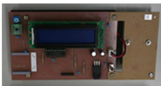
図4 リモコン部の内部基板
