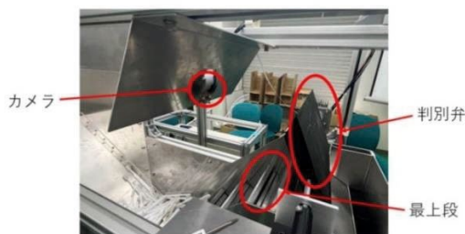
図 12. ステップフィーダ上部のカメラ
