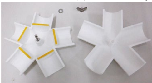
図 13 3D プリンタで制作したジョイント②
