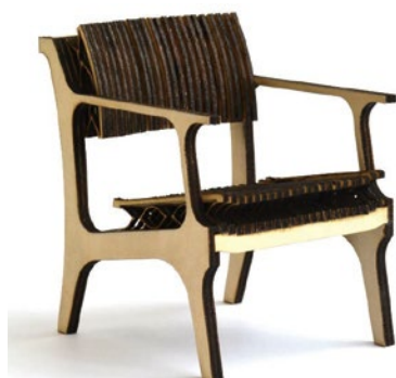
図 7 小型レーザー加工機で部品を加工した 1 : 10 スケールの模型
