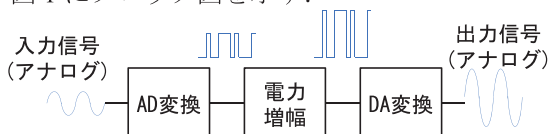
図 1 デジタルオーディオアンプのブロック図
