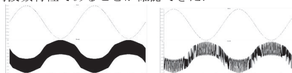
図 6.1 10[Hz], 1[kHz]入力時の入出力波形
