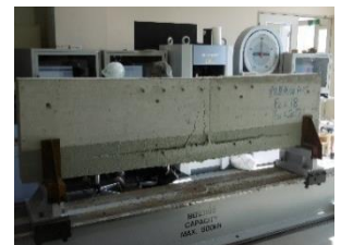
図 10 A 下破壊状況
