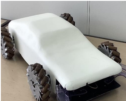
図11 ハンド搭載型全方向装置のFRPカバー
