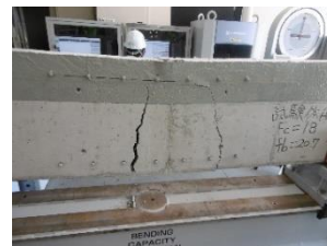
図 9 A 上破壊状況
