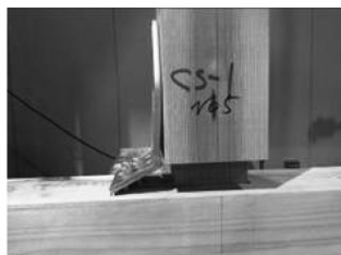
写真6 ビスの引抜け る。
