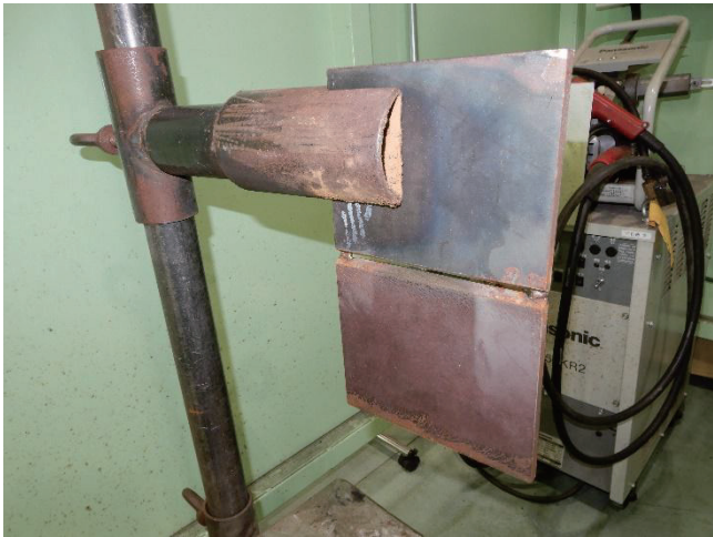
図 11 手・半自動溶接 横向き固定例
