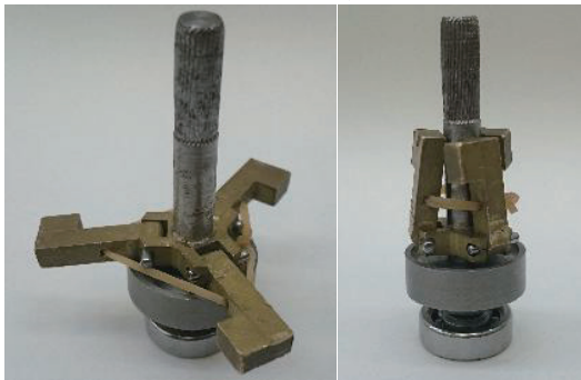
図3 ゴムの力で閉じる機構
