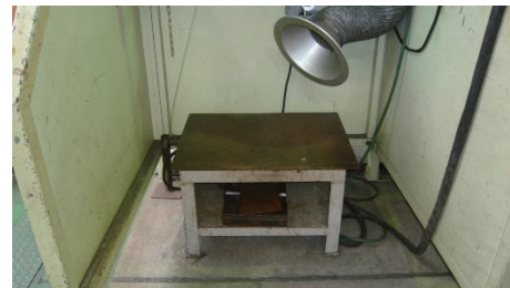
図4（旧）TIG溶接作業台全景
