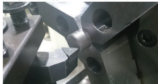
図14 生爪を使用した加工
