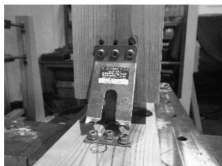
写真4 金物引張破壊
