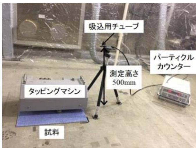
図3 測定時の外観
