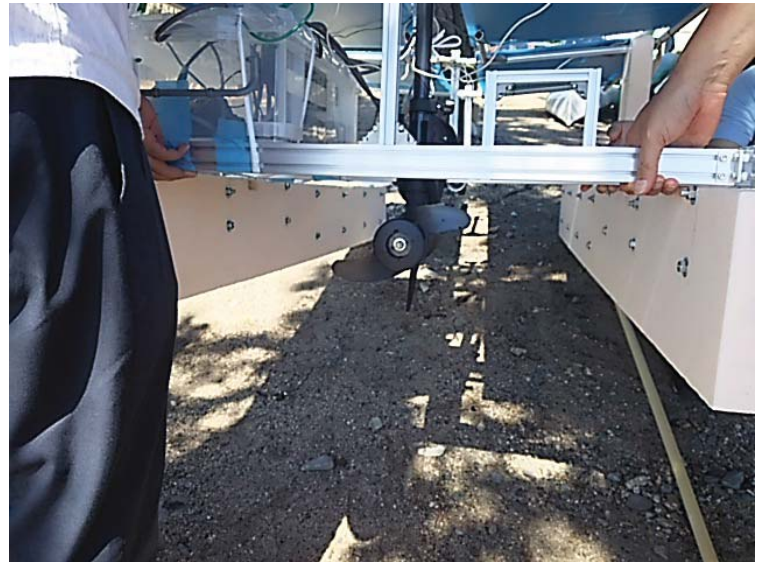
図7 船体後部 2枚プロペラが見える
