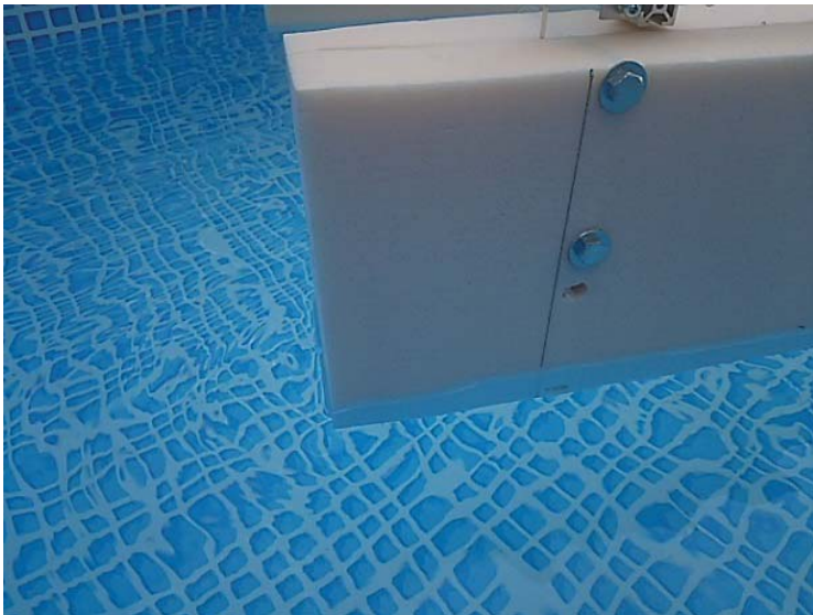
図6 カネライトフォームの沈み具合
