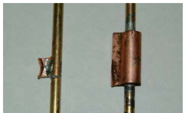
図6 磨耗した天符板(左)と改良後の天符板(右)
