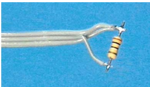
図 14 終端抵抗の取り付け
