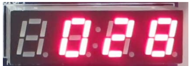
図6 十進数3桁7segLED点灯の結果
