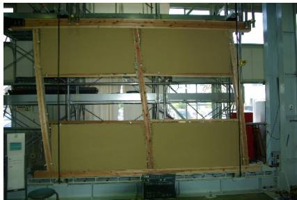
(a) 開口部を有する土塗壁の実大実験
