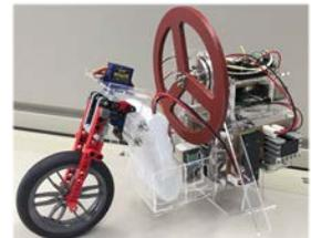
(f) 倒立振り子制御を活用した展示物（倒れないラジコンバイク）
