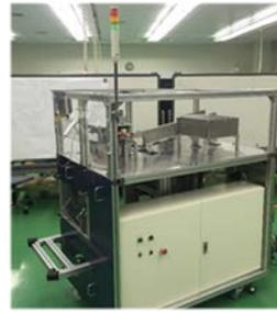
(a) 太陽光据置型架台支持瓦用ネジ供給機
