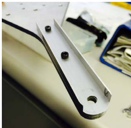
(b) 足部支え板補強外観
