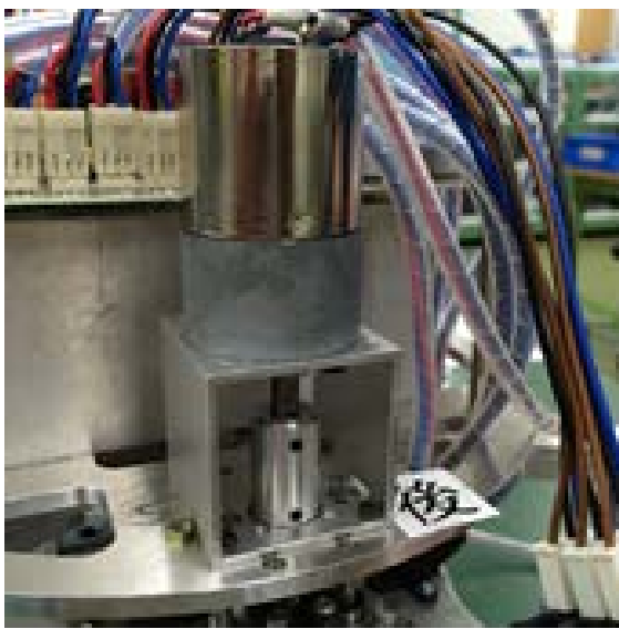
図 20 リジッドカップリングによる結合
