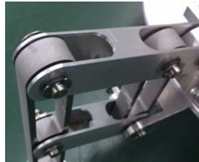
図18 E型止め輪による関節部結合
