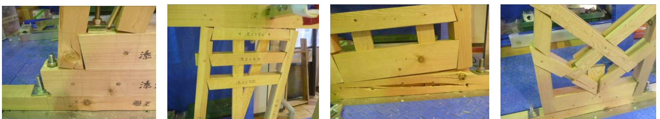
図9 1/2モデル耐力壁の破壊性状 (左より金物A, 金物B, 木造A, 木造B)
