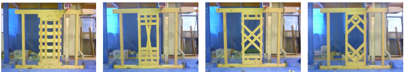
図8 1/2モデル耐力壁 (左より金物A, 金物B, 木造A, 木造B)
