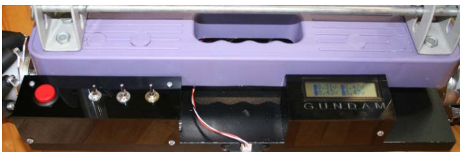
図 5 スイッチ操作部と LCD 表示部の外観
