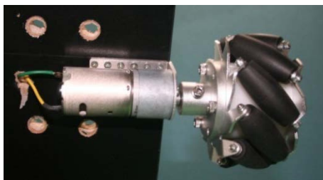
図 3 メカナムホイールと DC モータの取付け外観
