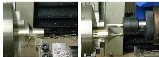
a) 旋削加工 b) ミーリング加工
