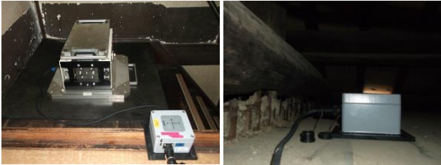
図 12. 振動測定状況（2 階）振動測定状況（天井裏）
