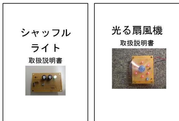
図 16 グループをさらに 2 班に分けて、それぞれがテキストとサンプルを制作した。このグループは動作すると光るテーマを採用し、本体を振ると LED が点灯する「シャッフルライト」(左)と羽の回転で華やかに LED の点灯を彩る「光る扇風機」(右)を制作した。
