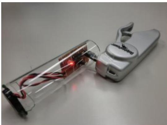
図 20 「発光☆戦隊メロデンジャー」は、図内右上部分を握ると発電して LED の点灯とメロディを奏でる。
