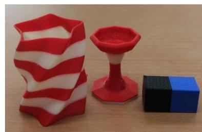
図3 2種類の材料での製作例
