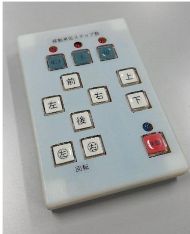
図10. ティーチングペンダント
