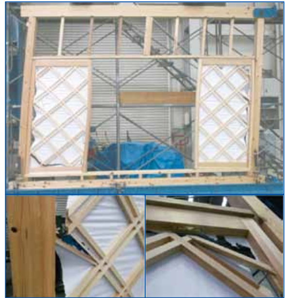
図11 試験終了時の破壊状況
