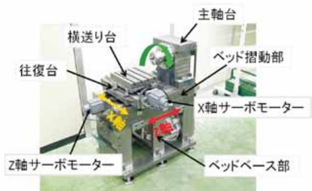
NC 旋盤の構造 (p46)
