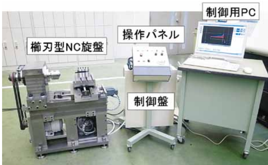
NC 旋盤の構成 (p45)
