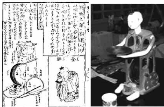
図1 機巧図彙と復元された茶運び人形
