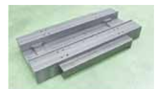
図6 往復台のガイド、ボールネジ取付け部
