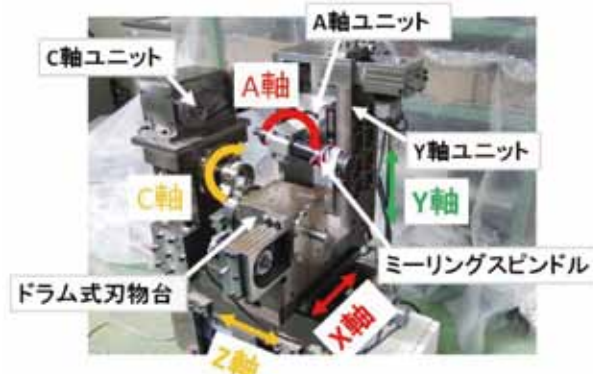
図 17 ターニングセンタの構造
