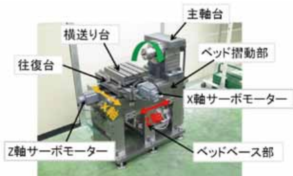
図3 NC旋盤の構造
