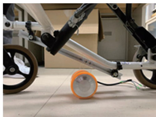
図3 中央に配置されたモータ
