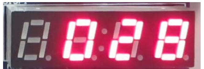
図6 十進数3桁7segLED点灯の結果
