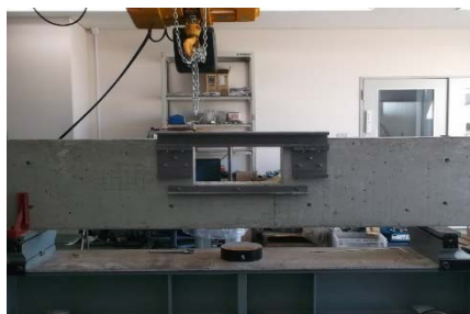
(c) 住宅用無筋コンクリート基礎補強工法の開発
