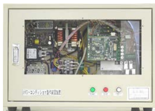
図 1 パワーコンディショナ実習装置
