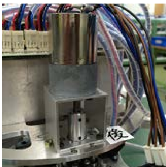
図 20 リジッドカップリングによる結合
