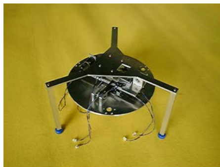
図6 固定脚（組立状態）
