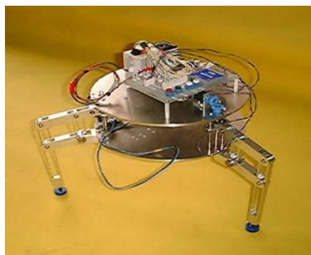
図8 リンク脚（組立状態）
