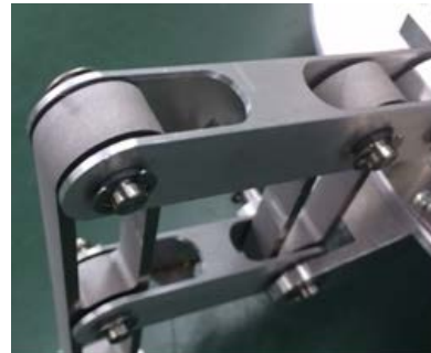
図18 E型止め輪による関節部結合
