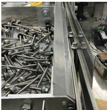
図4 製作したせりあがり機構
