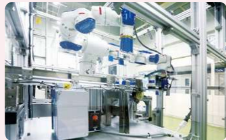
D棟に導入されたロボットコース用の双腕ロボット
