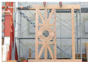
沖縄伝統工法の「ヌチジャー」を用いた耐力壁を作製し、水平加力試験を行いました。
