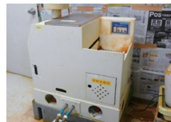
銅箔を溶かしてプリント基板を製作します。
