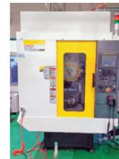
自動工具交換機能(ATC)をもったNC工作機械で、NCプログラムの命令により可動する切削加工装置です。
