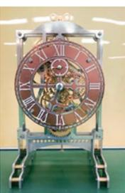
電気を一切使用せず、ぜんまいのみで動く機械式時計です。時間ずれも少なく高精度です。
