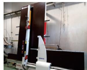
木材(板材・角材)を台にセットして、必要な寸法を入力し、自動的に直線切断することができる機械です。
