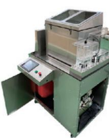
金属に生じる錆の腐食挙動を促進させ、製品の防錆能力を短い時間で評価する装置です。
