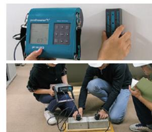
鉄筋コンクリート造内部の鉄筋の有無やかぶり厚さ、劣化・剥離検査・強度およびクラック深さを測定し、建物の劣化具合を測定する機器です。
