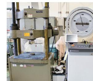
コンクリートの供試体(テストピース)の上下端面に圧力をかけ、硬化したコンクリートの圧縮強度を確認するための試験機です。
