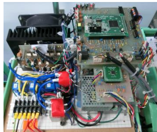
製作したパワーコントロールユニット
