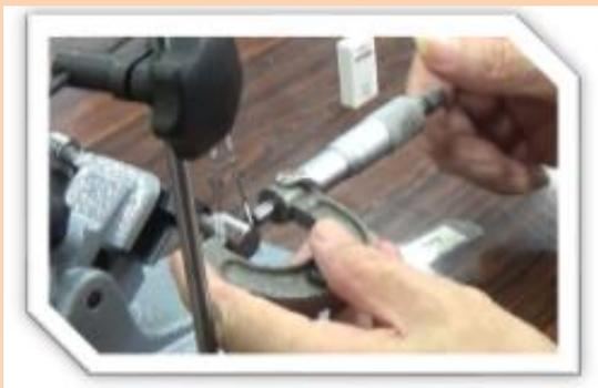
部品の寸法やねじの有効径を測定する
