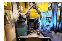
●溶接ロボット
