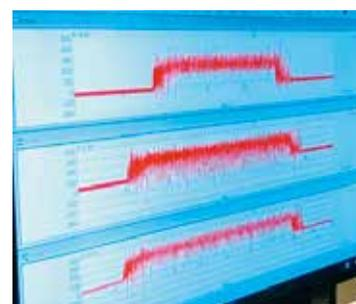
切削条件を変えながら、加工中の工具への負荷を測定し、
