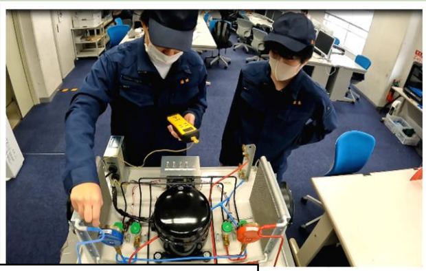
ヒートポンプ実験
