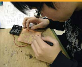
コンピュータで使用される電子部品、センサー、電子回路などを理解し、デジタル回路やアナログ電子回路を組み合わせた電子機器製作に必要な技能・技術を身につけます。
