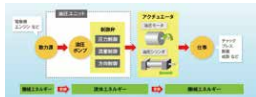
▲油圧装置の仕組み（出典 https://www.hyd.daikin.co.jp/seminar/seminar_01 ）
