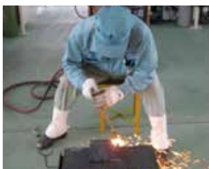
ガス切断作業
