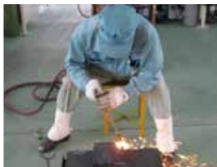
ガス切断作業
