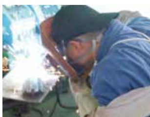
半自動アーク 溶接作業
